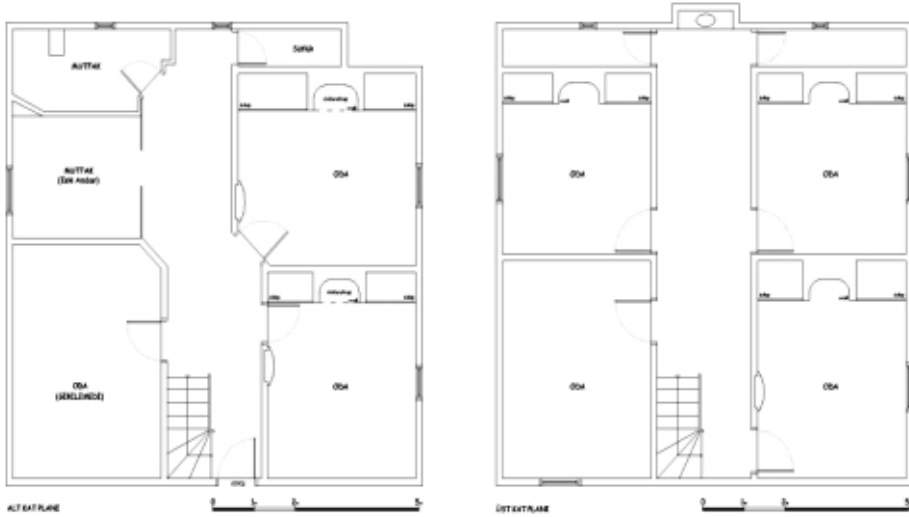
Çizim-9 İç sofalı plan, Aşağı Sayık Köyü, Şaban Duman Evi, alt ve üst kat planı
