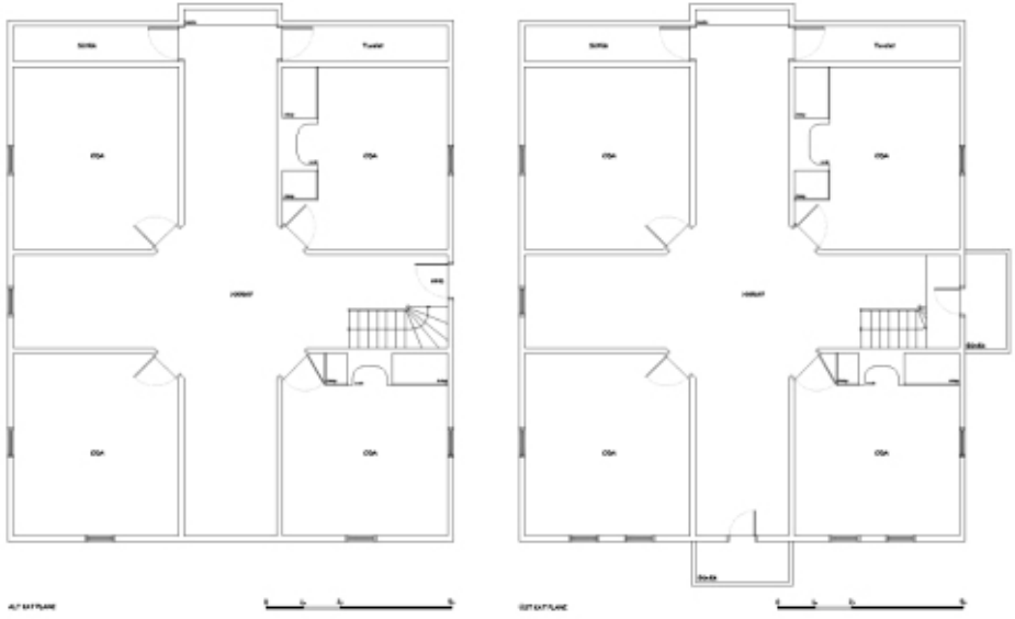
Çizim-12 Orta sofalı plan, Deveciler Mahallesi, Şahoğlu Evi, Alt ve Üst Kat Planı
